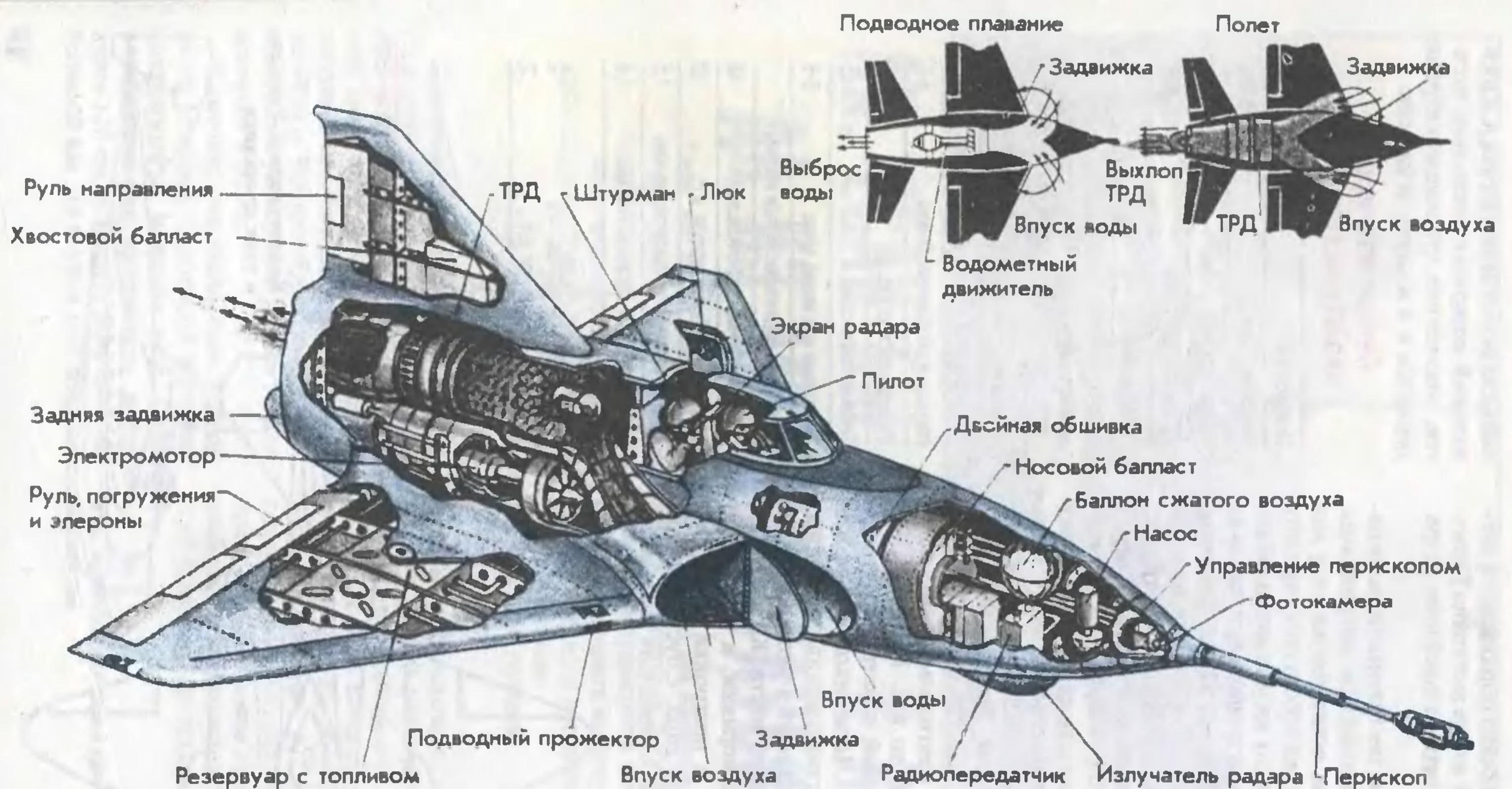
Разрез аппарата Д.Рейда. 9 июля 1964 года на глазах у многочисленной публики он опустился на воду и,грузившись на глубину 4 м, прошел около 4 миль со средней скоростью 7,5 км/ч. Затем, избавившись от водного балласта,
